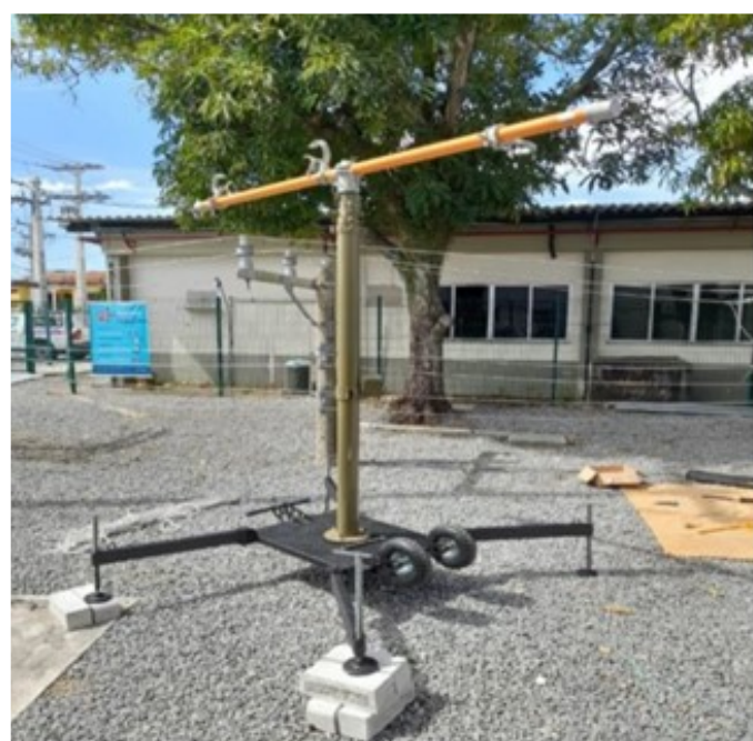
Fig. 4 Cabeçote e Cruzeta auxiliar isolada 15 KV. Fonte: Autores
